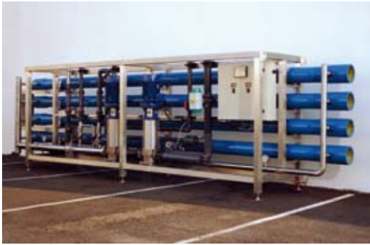
Photo : osmose inverse 35 m 3 /h
